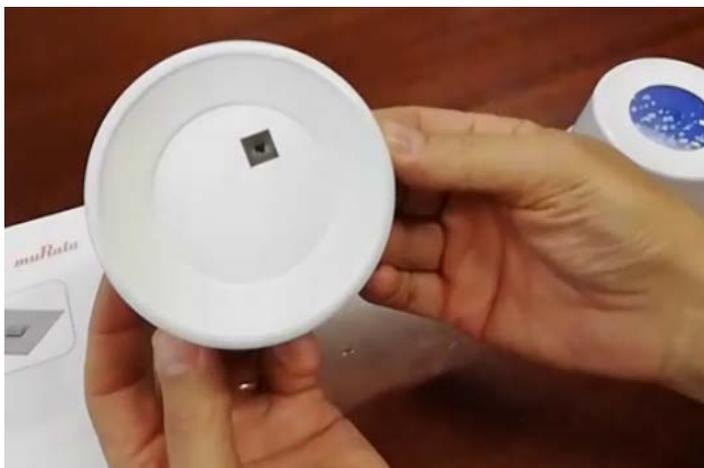
Thermogeformte Portions-Becher mit eingebautem Chip, les- und beschreibbar mittels NFC-Geräten. NFC-Technologie ist in jedem Smartphone eingebaut und wird bei neuen Modellen, wie z. B. dem iPhone XI®, immer weiter verbessert.
